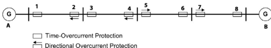
شکل ۳-۲: خطوط انتقال با تغذیه از دو سمت
